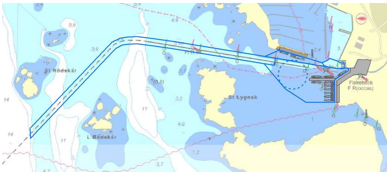
Bild 2. Befintlig inseglingssränna till Fiskebäcks Hamn med nuvarande bredd och djup. Troligaste scenariot är att det är denna sträckning som kommer breddas, fördjupas och anpassas genom muddringen.
