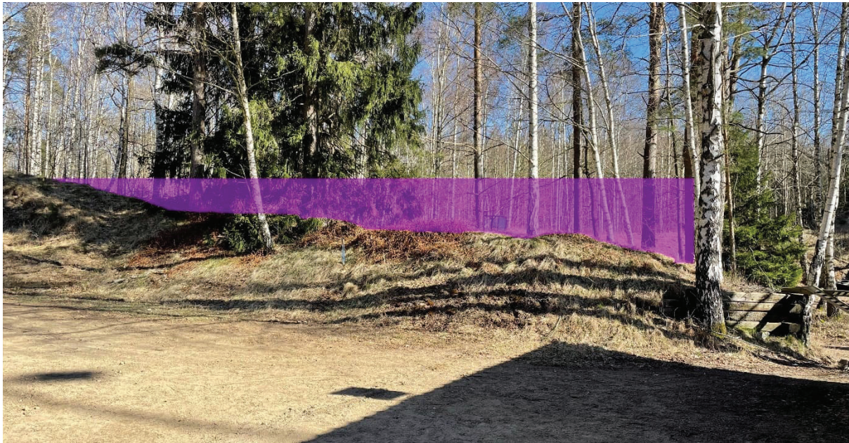
Figur 9. Det lila området markerar föreslagen justering av vallen så att ett ca 40 m långt avsnitt får markhöjd ca 91 m.ö.h.
