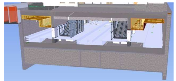
Figur 7, Installationsstråk markerat i gult
