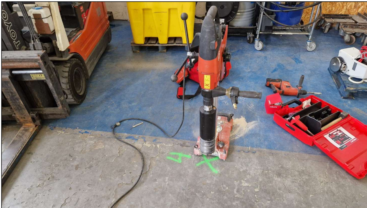
Figur 11. Bild över kärnbörning av betong © Norconsult.
