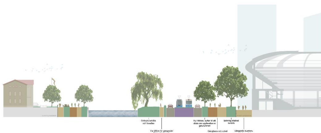
Figur 5. Sektion Stampgatan-Ullevigatan, i höjd med Gamla Ullevi. Spårväg i Ullevigatan, förstudiens förslag till sektion med mittförlagd spårväg.
