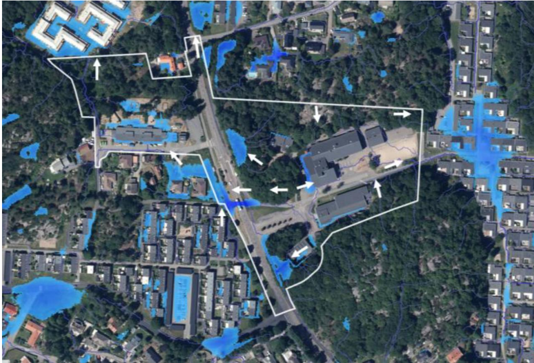
Figur 36. Vattenansamlingar i lågpunkter och rinnvägar vid 68 mm regn med hänsyn till infiltration. Pilar visar översiktlig rinnriktning.
