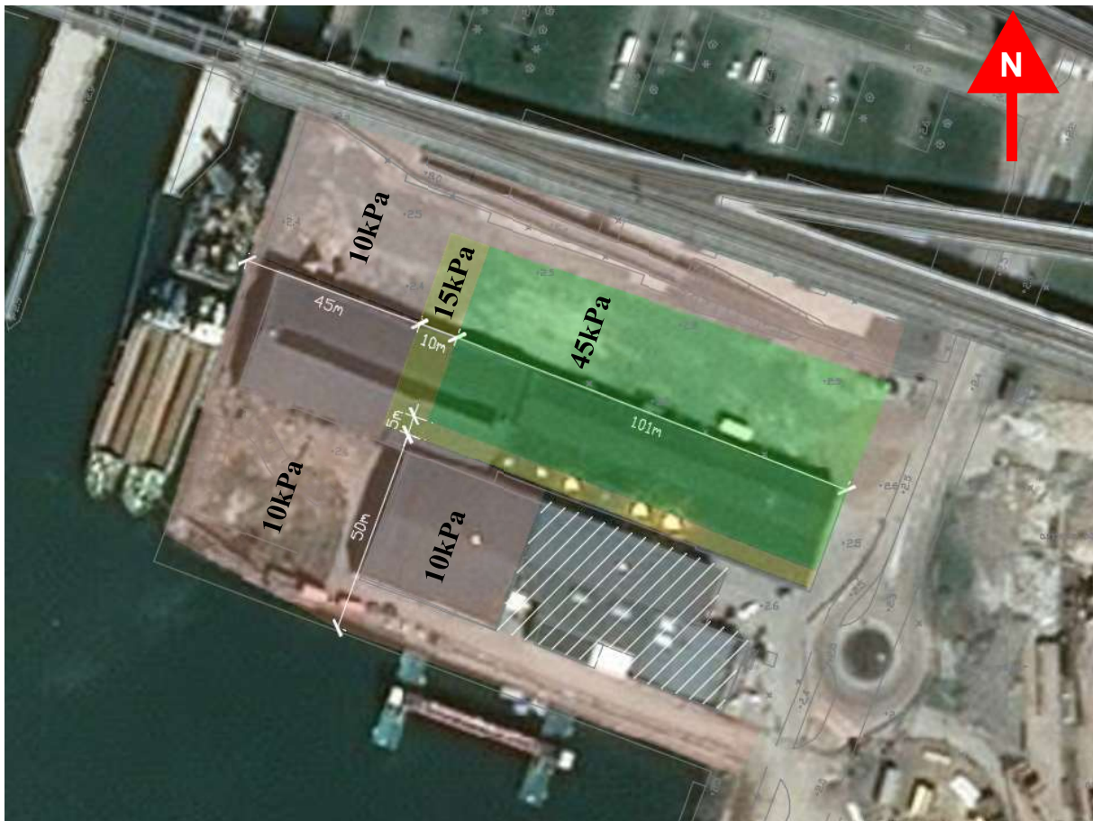
Figur 3. Lastbegränsning inom fastighet Gamlestaden 27:5. Bedömning av lastbegränsningar inom skräfferad yta ingår inte i föreliggande utredning. Lastbegränsning: Röda ytor: 10kPa, Gula ytor: 15kPa, Gröna ytor: 45kPa
