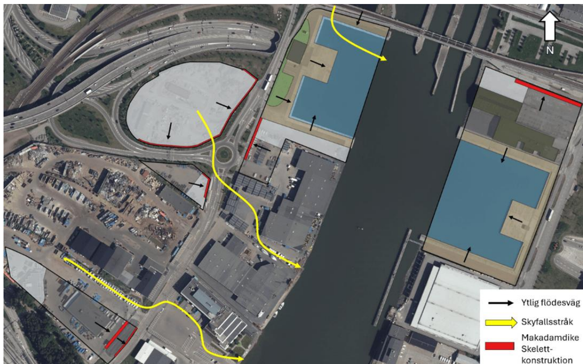
Figur 21. Sammanställning av dagvatten- och skyfallsåtgärder.
