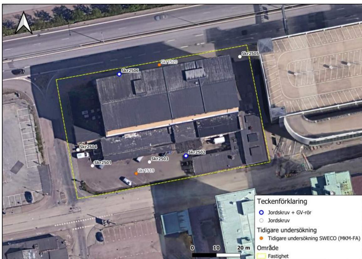
Figur 2. Placering av jordskruvar och GV-rör inom undersökningsområdet.
