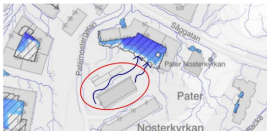
Figur 9. Bilden illustrerar befintliga rinnvägar (blåa linjer) till lågpunkter (blåa områden) utanför planområdet. Källa: SCALGO Live
