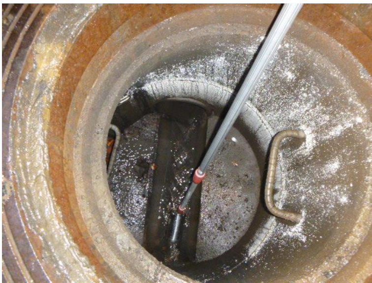
Figur 7. Provtagning med vattenhämtare. Foto tagit vid en av provtagningspunkterna i Lärjeån, vid provtagningspunkt LÅ_Dv_1 av Fredrik Albertsson 2025-12-02.
