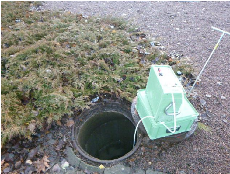
Figur 6. Provtagning med peristaltisk pump. Foto tagit vid en av provtagningspunkterna i Kvillebäcken, vid provtagningspunkt KB_Dv_1 av Fredrik Albertsson 2025-11-28.
