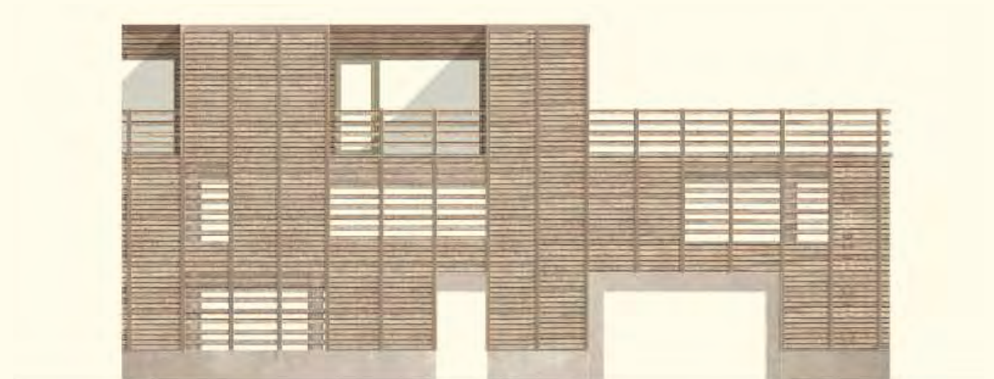
Figur. 52 Fasadalternativ med sockel av betong och vägg av trälameller/träpanel. Illustration: Kjellander Sjöberg Arkitekter.
