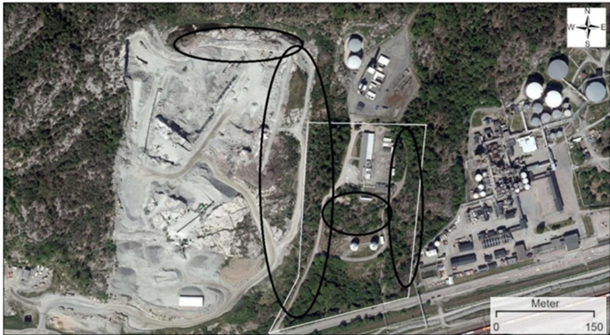
Figur 12: Karta från den bergtekniska undersökningen, där svarta inringningar visar var sprickmätningar har genomförts. Källa: Norconsult Sverige AB (2026b).
