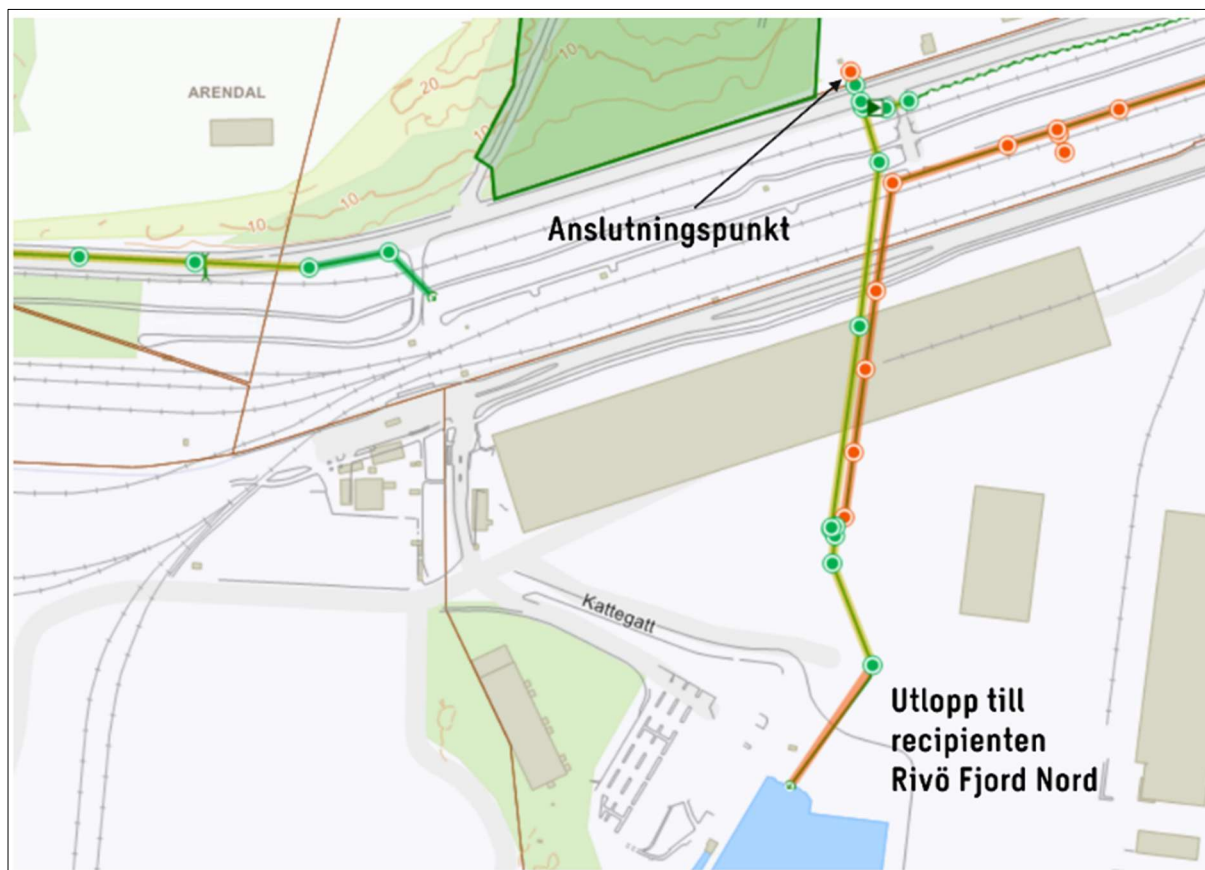
Figur 17. Befutligt ledningsnät kring planområdet där gröna punkter symboliserar tillräcklig kapacitet och orange punkter visar trycknivåer som innebär risk för marköversvämningar. Information från Göteborgs stad, Kretslopp och Vatten (Sweco, 2026).
