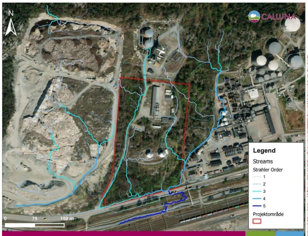
Figur 33: Beräknade vattenflöden för Göteborg Energis fastighet och närområde. Relativa vattenflöden visas i form av strömmordning (Strahler-order) där de högre värdena innebär ett kraftigare flöde. Karta framtagen av Calluna AB (2024).
