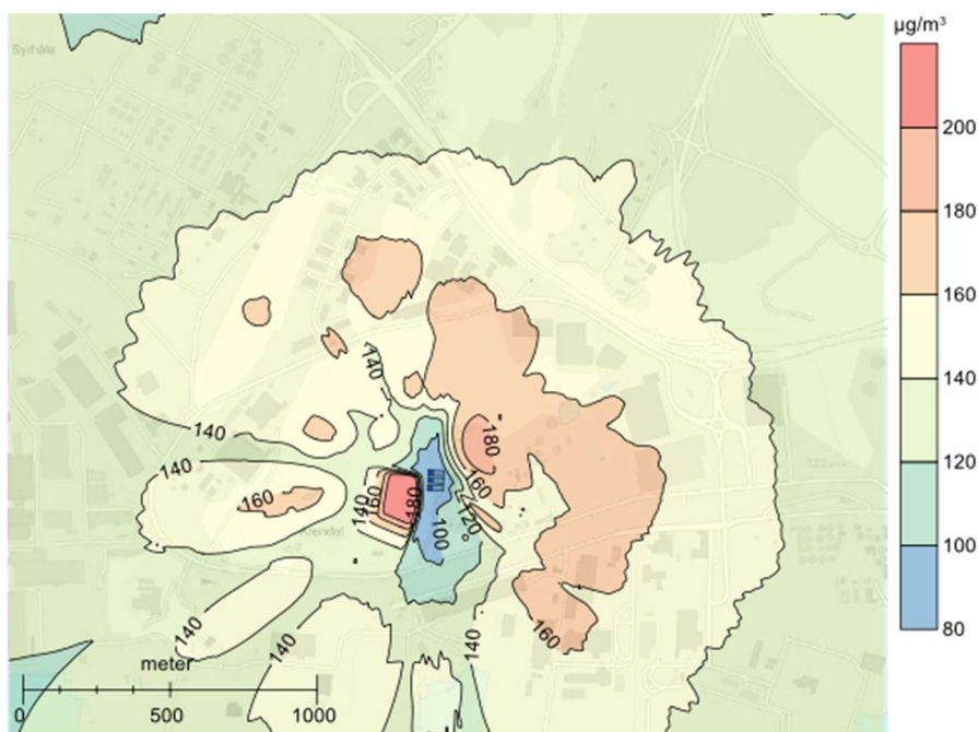
Figur 24: 99,97-percentil av timmedelvärde totalhalt NO 2 µg/m 3 gällande flytande bränsle med 50 meter hög skorsten. Rödare områden markerar plymnedslag för högre halter av kvävedioxid. Källa: COWI (2025).
