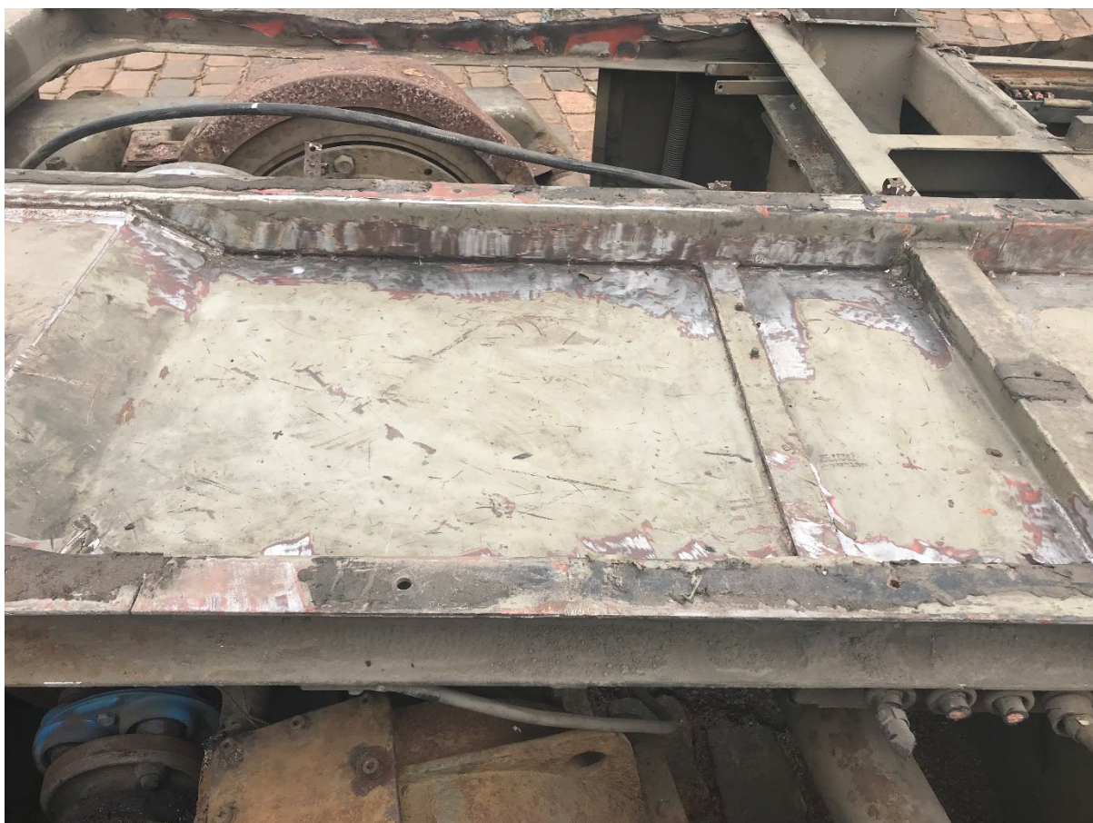
Figur 11 Sanerat ramverk - notera renslipade ytor där asbest avlägsnats
