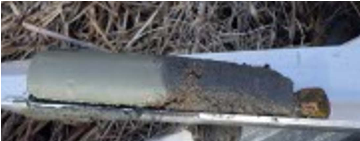
Figur 2 Bottensediment (sand & grus) på lera.
