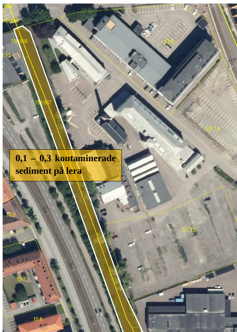
Figur 7 Illustration av föroreningssituationen i sedimenten i Mölndalsån.
