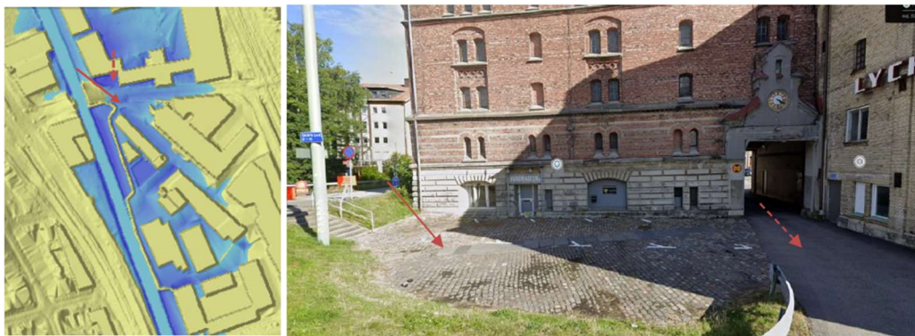
Kritiska punkter inom fastigheten Skår 40:5, direkt norr om planområdet: tröskelpunkt markerad med heldragen pil; ytterligare problempunkt vid portgång markerad med streckad pil. (Ramböll)
