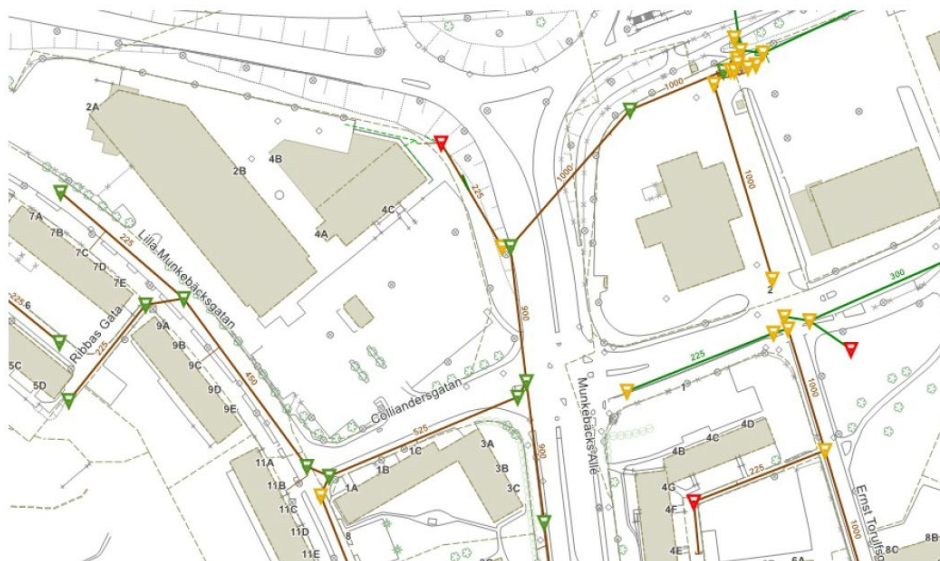
Figur 9. Maximal vattennivå i ledningsnätet relativt med marknivå/ledningshjässa vid dimensionerande 20-års regn (VA-banken, 2022).
