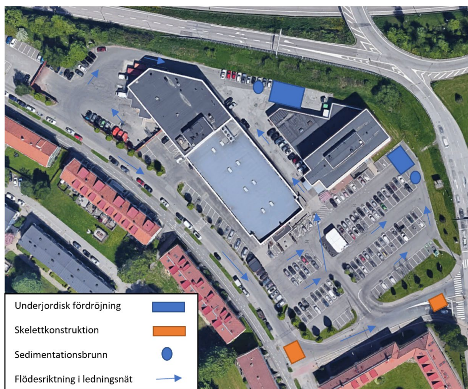
Figur 16. Schematisk figur över föreslagen dagvattenhanteringen på området.
