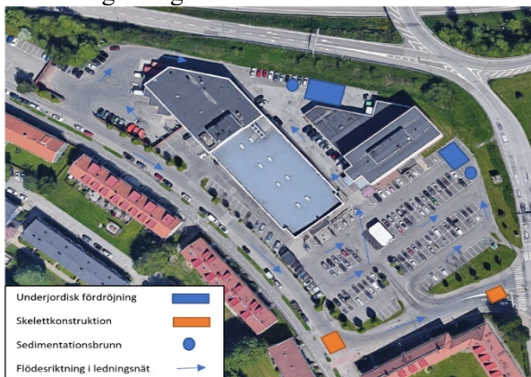
Figur 1. Schematisk figur över dagvattenhantering på planområdet
