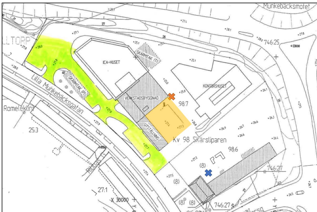
Figur 6. Äldre planritning över aktuellt undersökningsområde. Kålltorp 98:6 var tidigare indelad i två fastigheter: Kålltorp 98:6 och Kålltorp 98:7. Grönfärgat område visar ungefärlig utbredning av tjärindräkt makadam inom fastigheten. Ungefärlig position för den gamla oljeavskiljaren ses markerat med blått kryss. Ungefärlig position för borrhyp där oljelukt tidigare noterats ses markerad med orange kryss. Gul färgat område representerar den yta där förorening överskridande MKM påvisades och där ICA senare byggde ut sin verksamhet. Källa: Hifab.
