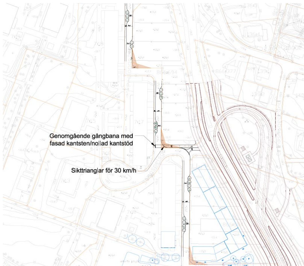
Figur 27 – Principritning för sicksackgatans utformning.
