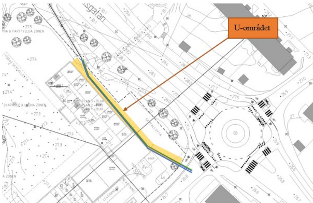
Figur 2. Förslag på ledningsomläggning i Almquistgatan baserat på befintlig skiss.
