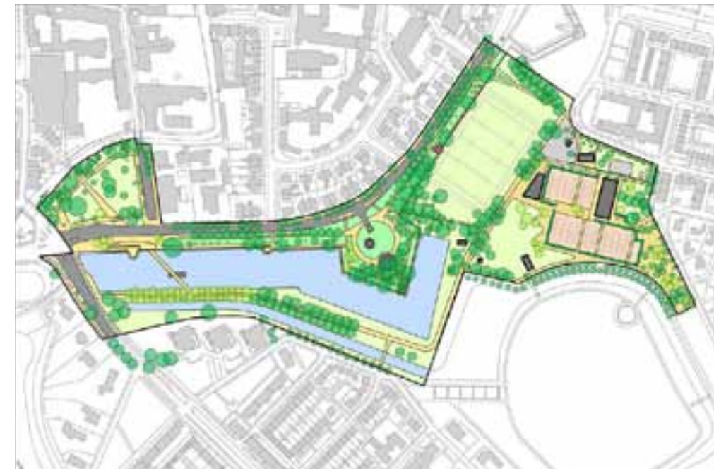
SITUATIONSPLAN. PÅ BASTION BASELAAR FINNS P-GARAGETS ENTRÉ. SJÄLVA P-GARAGET FINNS UNDER DEN ÅTERSTÄLLDA KANALEN. EN NY PROMENADBRO FÖRBINDER P-GARAGETS FOTGÅNGARE-UPPGÅNG MED STADSKÄRNAN OCH DETTA GENOM EN NY ÖPPNING I STADSMUREN ILLUSTRATION: MTD LANDSCHAPSARCHITECTEN
