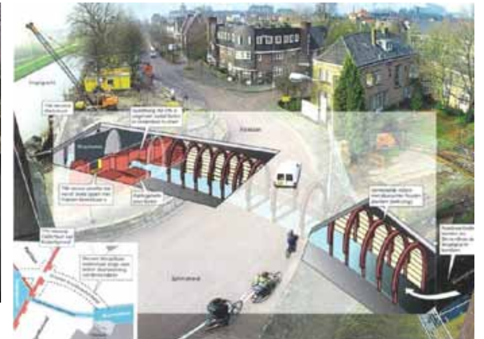
ÅTERSKAPANDET UNDERJORDISK VATTENFÖRBINDELSE KRUISBROEDERSHEKEL. BILD: DEN BOSCH KOMMUN
