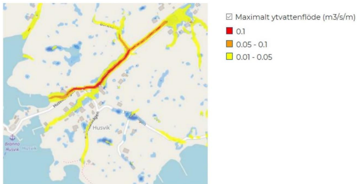
Ytvattenflöden vid ett 100-årsregn
