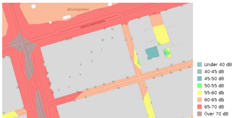
Bullerkarta, visar trafikbullers utbredning ekvivalentnivå dBA, baserad på 2018 års trafikdata
