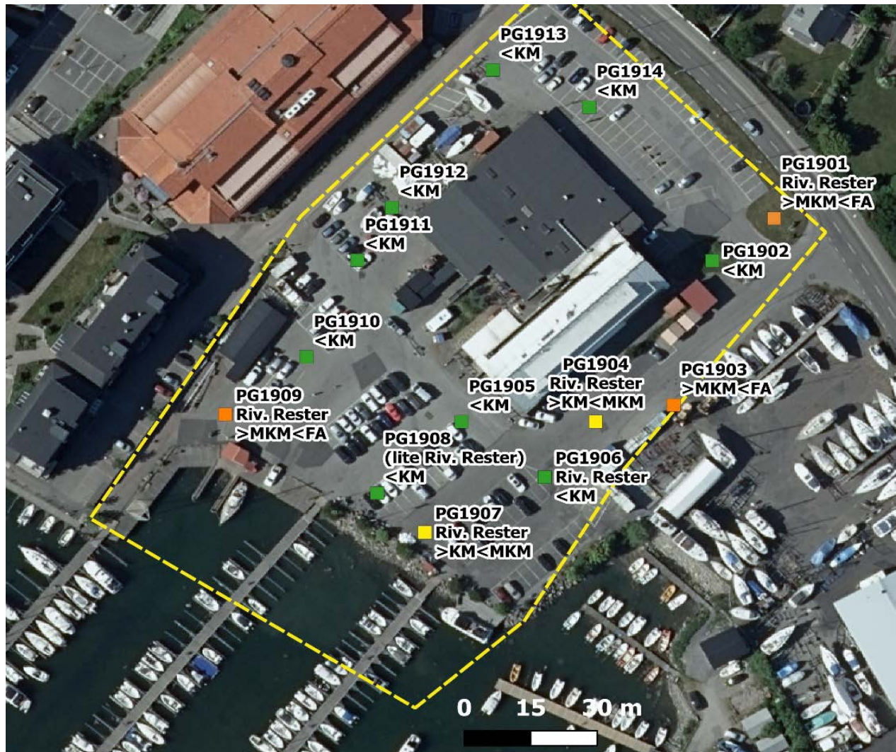
Figur 7. Översiktsbild som visar klassning samt var rivningsrester påvisats i fyllnadsmaterial. Orange ruta indikerar >MKM <FA, gul ruta indikerar >KM <MKM och grön ruta indikerar <KM (inga föroreningar).
