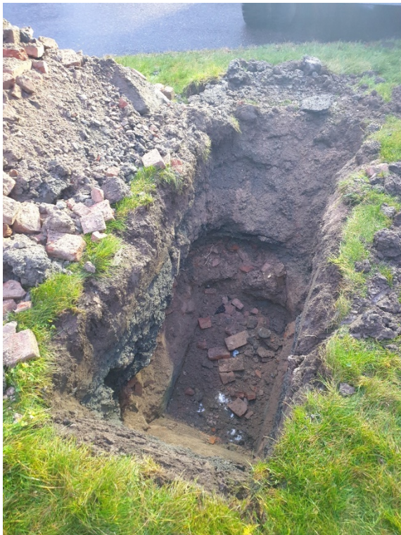
Figur 5. PG1901 som visar fyllning under äldre lager av bitumenasfalt där tegel återfinns.
