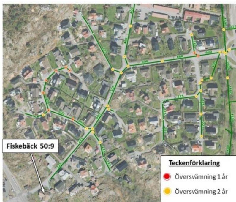
Figur 4. Teoretiskt beräknad kapacitet i dagvattensystemet nedströms Fiskebäck 50:9.
