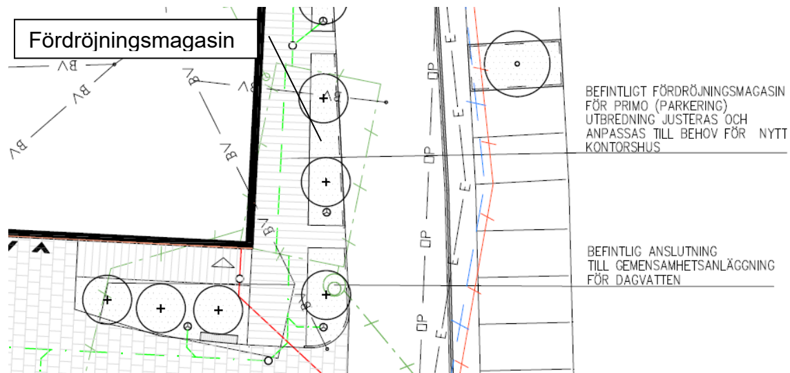
Bild 2 - Va-system i södra delen för Primohuset.
