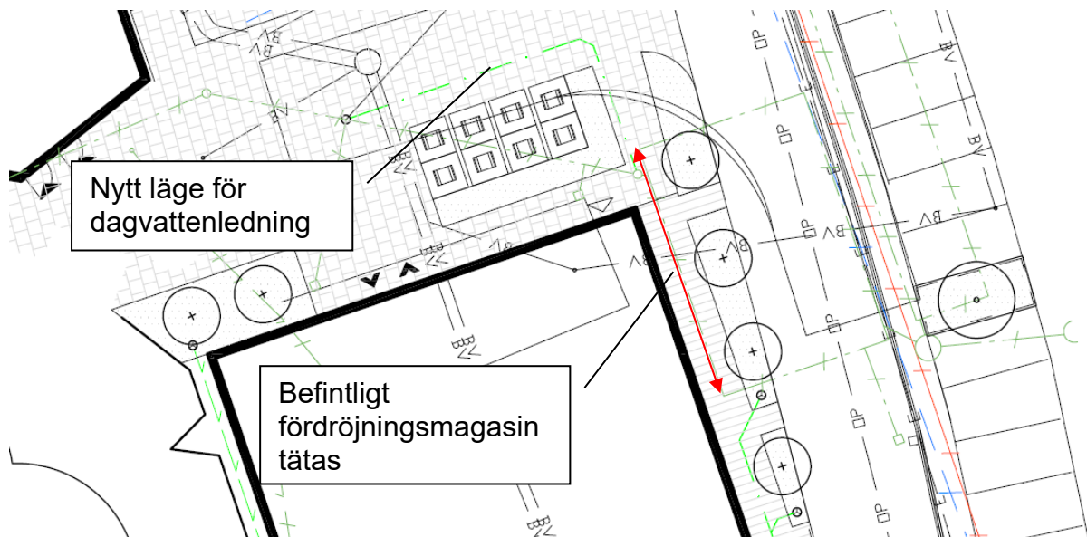
Bild 4 - Justeringar av befintlig dagvattenanläggning från tak och ytor vid Primohuset
