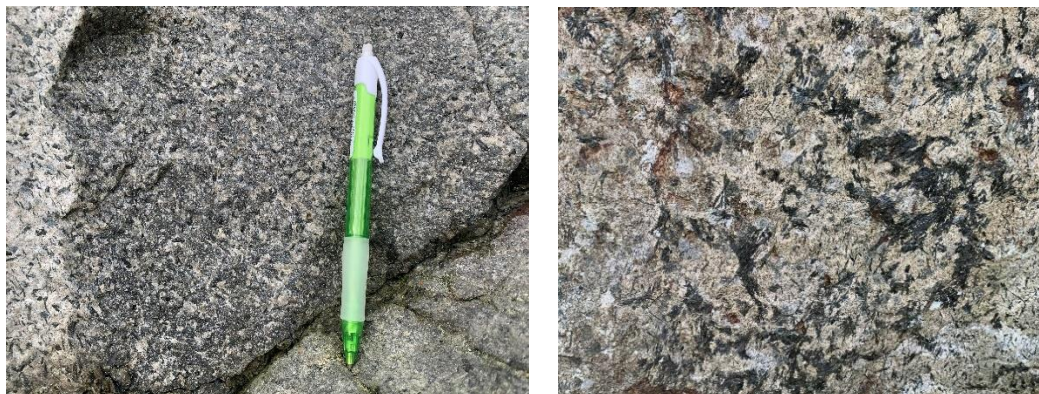
Figur 3.1.1 Förekommande bergarter: medelkornig till grovt medelkornig granit och skriftgranit med strålliknande kristaller av biotit.
