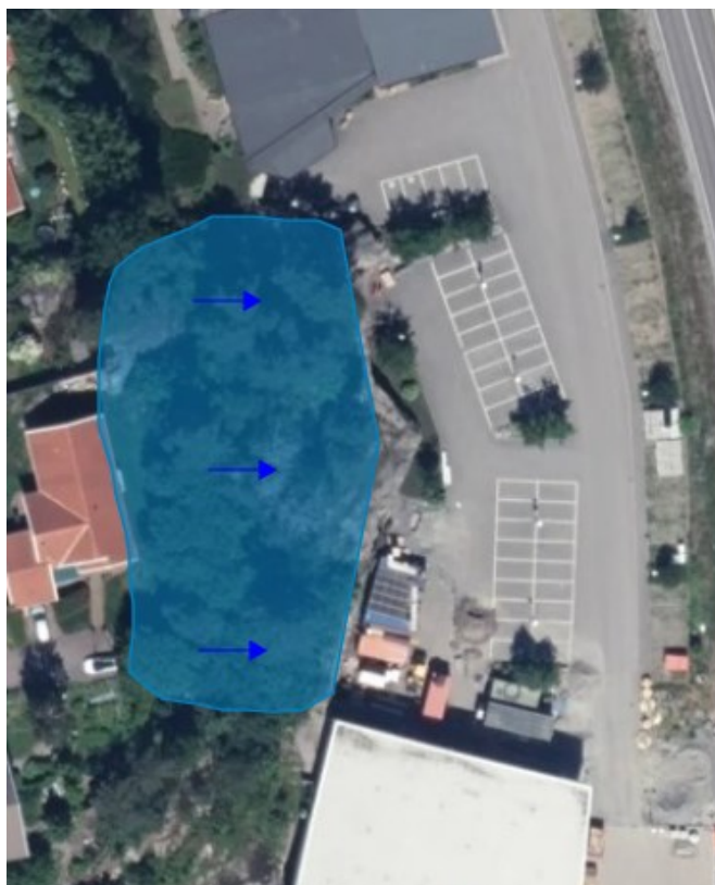
Figur 25: Avrinning från berg mot planerad byggnad efter tänkt ombyggnation
