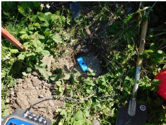
Bild 1. Placering av givare till mätpunkt 3, före jordtäckning.
