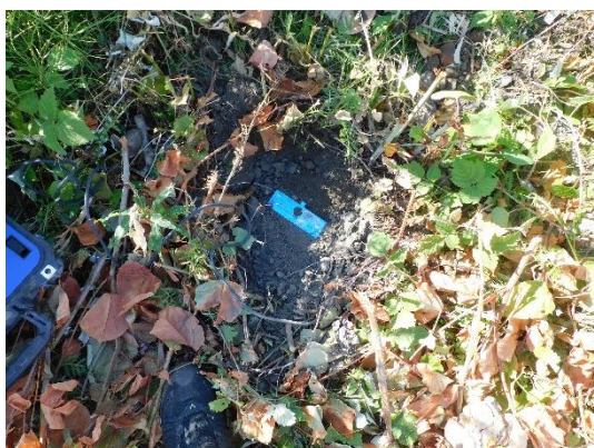
Bild 1. Placering av givare till mätpunkt 1, före jordtäckning.
