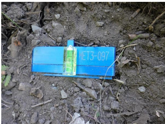
Bild 1. Placering av givare till mätpunkt 2, före jordtäckning.
