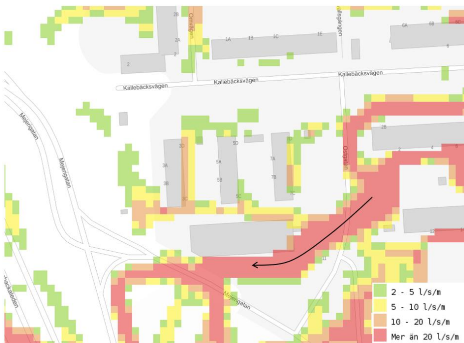
Figur 3, ytvattenflöden vid planområdet i samband med ett klimatanpassat 100-årsregn. Svart pil markerar vattnets flödesriktning
