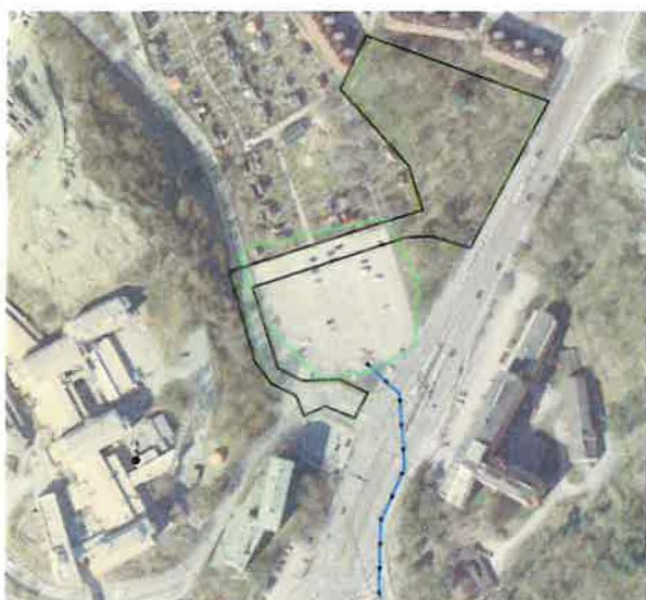
Föreslagna strukturplaneåtgärder för hantering av skyfall är en skyfallsyta (grönt) och en skyfallsled (blå med pilar). Svart polygon markerar planområdet.
