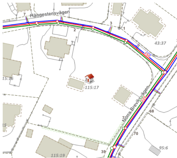
Figur 9. Ledningskarta, Kretslopp och vatten (Kov)
