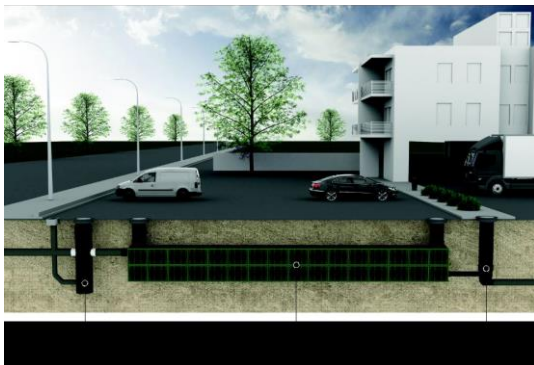
Figur 24 Exempel på system med dagvattenkassetter (Källa: Fränkische)
