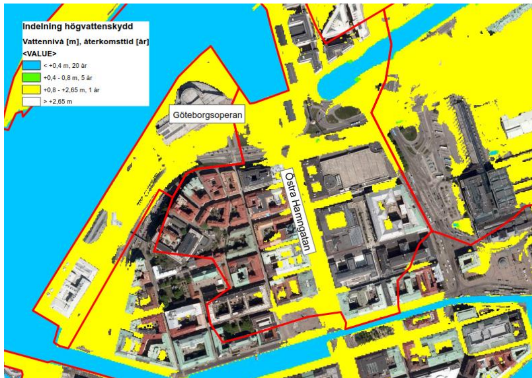
Figur 7. Indelning av högvattenskydd efter återkomsttid och vattennivå inom Exportgatans avrinningsområde med dagens klimat.
