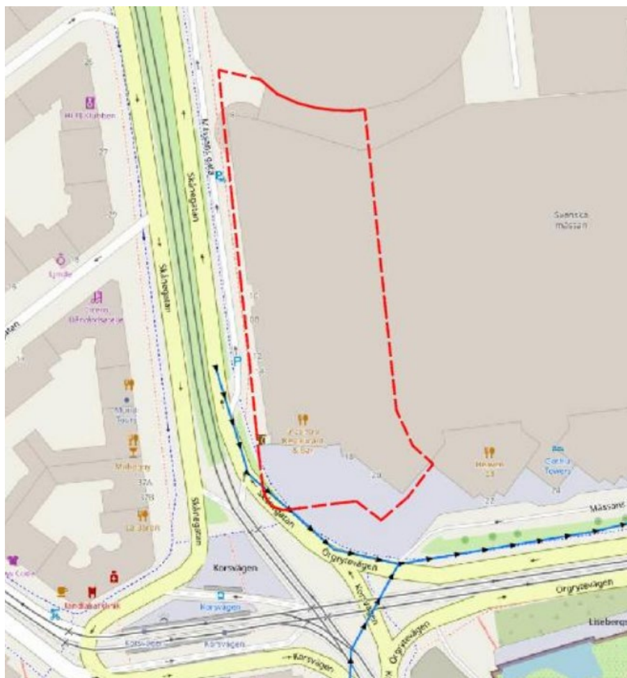
Bilden visar föreslagna strukturplansåtgärder för området. Översvämningsytor i grönt, skyfallsleder i blått, samt styrningsåtgärder i rött. Ungefärligt planområde är markerat med streckad röd linje. Bild dagvattenutredning
