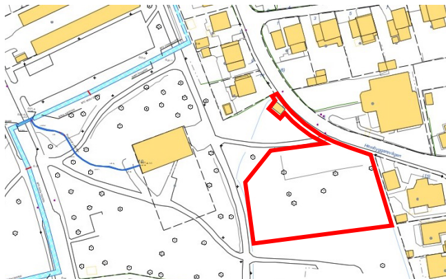
Befintlig fjärrvärmeledning (ljusblå linje) nordväst om planområdet.
