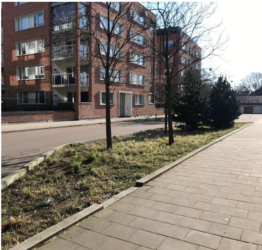
Figur 23 Regnbädden har öppningar på lämpliga ställen för att dirigera regnvatten till bädden (Foto: Maria Holmes)
