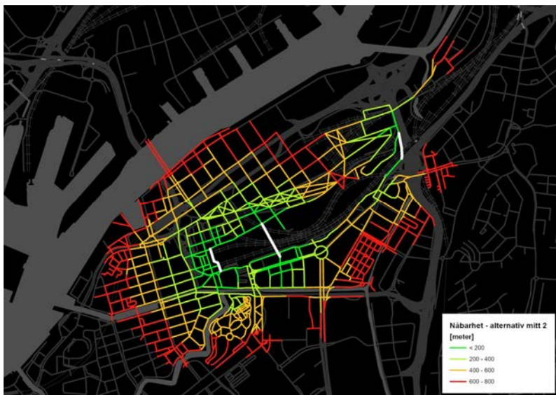
Näbarhet mellan norra och södra sidan av bangården, mittläge
