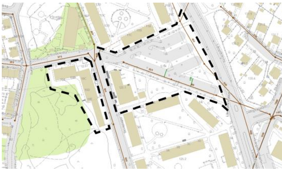
Figur 8 Utdrag från VA-banken. Kombinerade ledningar finns i Jättestensgatan, Långströmsgatan och inne på planområdet.
