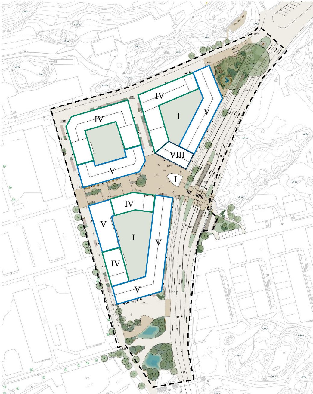
Figur 24 Illustrationsplan med högsta antal våningar. I plankarten regleras inte antal våningar utan högsta nockhöjd över angivet nollplan vilket innebär att antal våningar kan variera något beroende på om det är ett flackar eller brantare tak. Antal våningar som anges på illustrationen ovan utgår från sadeltak med maximal lutning på 35 grader. I illustrerade 3D-volymer och sektioner syns även exempel med flackare tak och några lägre byggnadsdelar. I två av kvarteren kommer en eller två delar behöva ha lägre antal våningar för att klara brandskydd- och dagsljuskrav. Delar av gatussektioner ligger redan på allmän plats (trafikområde) och ingår därmed inte i planområdet. Illustration av White arkitekter.
