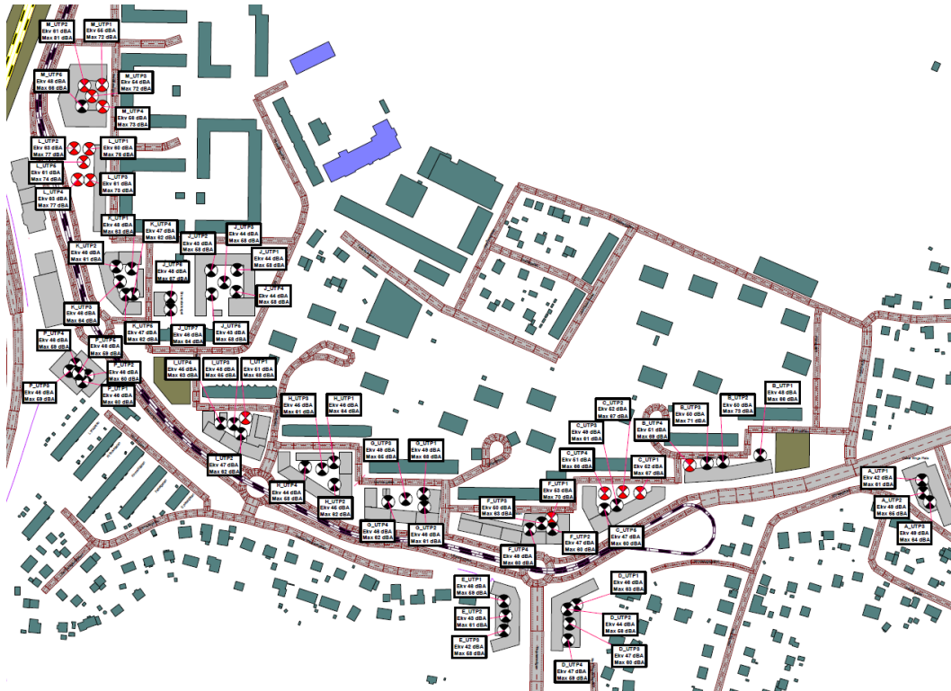
Figur 77 - Beräkningar avser ekvivalent och maximal ljudnivå från alla trafikslag i området för utbyggnadsalternativet år 2040. Ljudnivå vid uteplatser är beräknade med 3 reflexer och redovisas som frifältsvärden. Beräkningar är utförda 1,5 m ovan mark. Svarta beräkningspunkter innehåller gällande riktvärden. Röda beräkningspunkter överskrider gällande riktvärden. (WSP, 2025)
