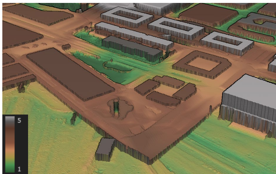
Figur 13: Höjdmodell som har använts för skyfallsmodelleringen. För att öka tydligheten i bilden har höjderna överdrivits och motsvarar i detta fall inte verkligheten (Sweco, 2025).
