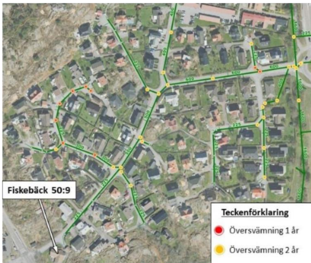
Figur 10. Teoretiskt beräknad kapacitet i dagvattensystemet nedströms Fiskebäck 50:9.
