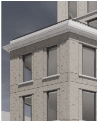
Exempel på avslut lågdel. Tydlig horisontell takfot markerar takavslut en bit ned på fasad.
