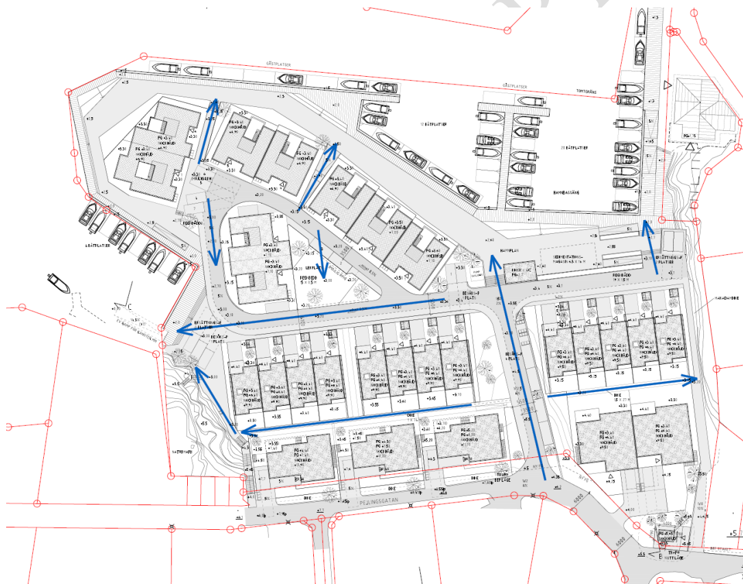
Figur 17. Karta visandes föreslagen höjdsättning av marken och färdigt golv i byggnader samt vattnets avrinningsriktningar (blå pilar).
