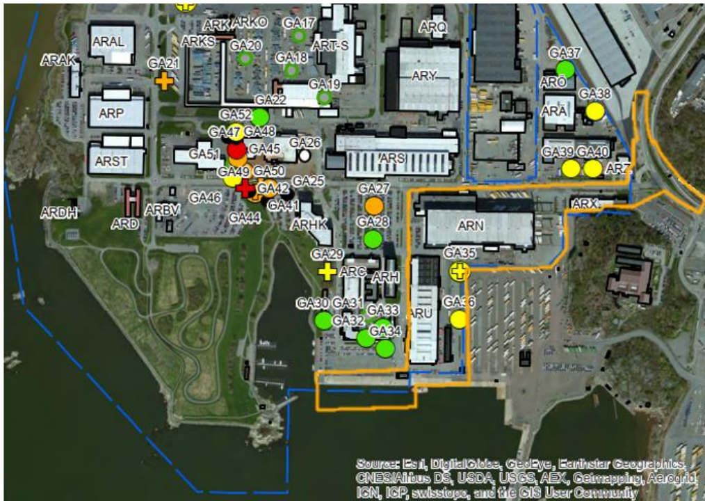
Figur 16. Utsnitt från karta avseende jordprovtagning 2016. Relevanta punkter för detaljplanen är framför allt G35-36 samt G39-40. Ungefärlig avgränsning av planområdet visas med orange linje. Källa: Golder Associates AB.
