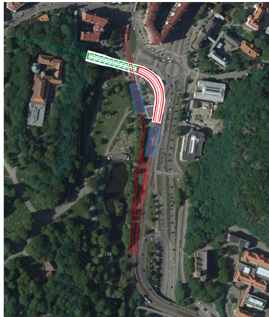
Lindholmsförbindelsens avtryck på Linnéplatsen. Röda heldragna linjer visar spår och tråg, synliga ovan mark. Grön streckad linje visar spår samt betongtråg under mark. Vit yta visar område för spontgrop, vilken kommer att bestå av ett öppet schakt under byggtid. Ytor utanför spontgrop kommer att påverkas under byggtid. Arbeta med att minimera intrång samt återställande pågår inom järnvägsplan och detaljplan.
