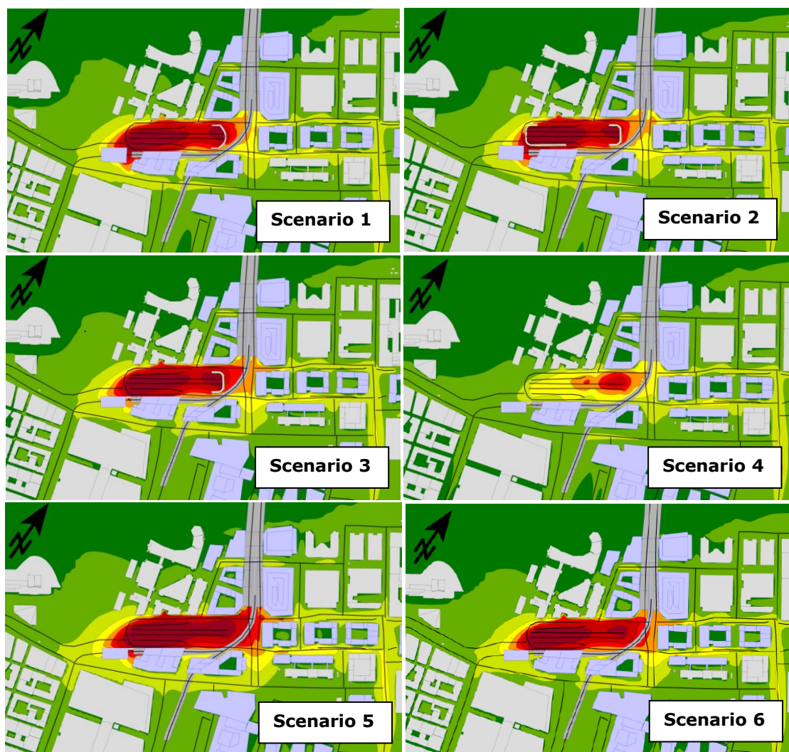
Figur 5-14. 98-percentilen av dygnsmedelvärdet av NO 2 (µg/m 3 ). Röd färg anger överskridande av MKN (60 µg/m 3 ).
