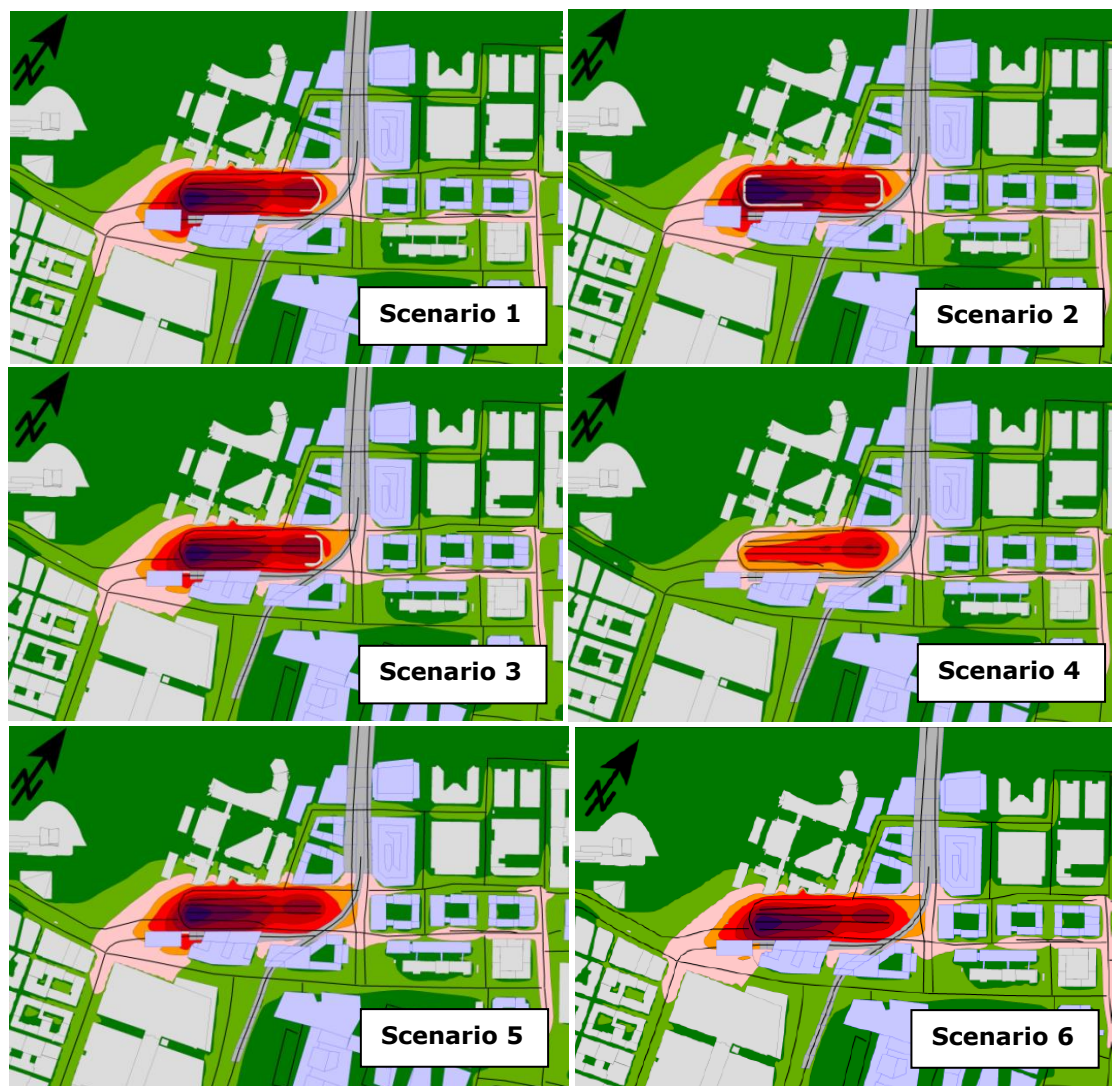
Figur 5-16. 90-percentilen av dygnsmedelvärdet av PM 10 (µg/m 3 ). Röd färg anger överskridande av MKN (50 µg/m 3 ) och rosa färg anger överskridande av miljökvalitetsmålet (30 µg/m 3 ).
