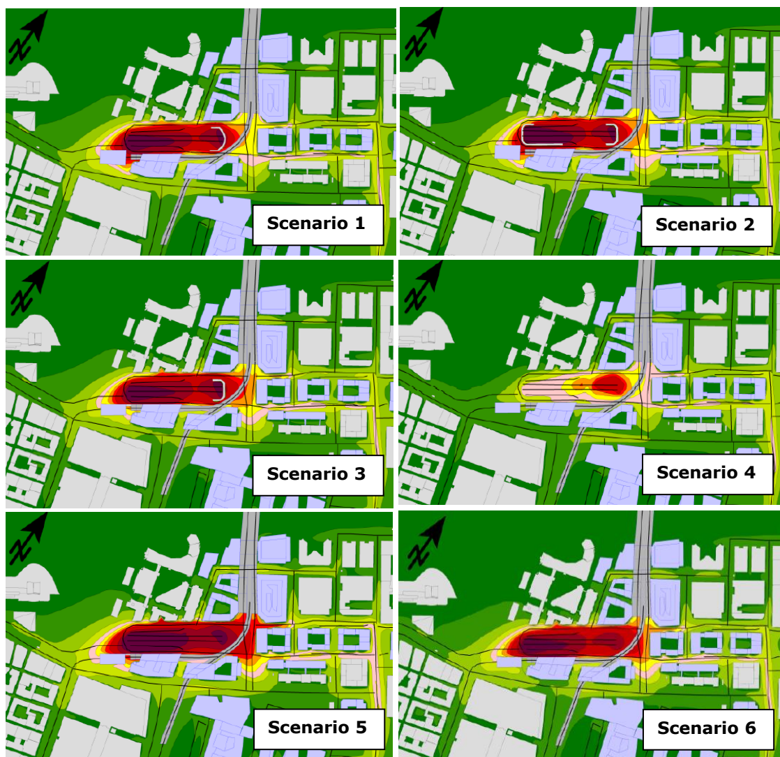
Figur 5-15. 98-percentilen av timmedelvärdet av NO 2 (µg/m 3 ). Röd färg anger överskridande av MKN (90 µg/m 3 ) och rosa färg anger överskridande av miljökvalitetsmålet (60 µg/m 3 ).
