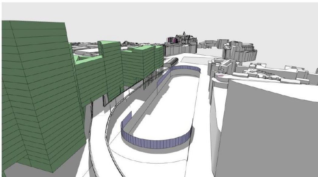
Figur 5-9. Scenario 2 - Förlängd överdäckning, en 6 meter hög skärm på Bananbron vid överdäckningens västra tunnelmynning och en 6 meter hög skärm vid Götatunnelns mynning (år 2028)
