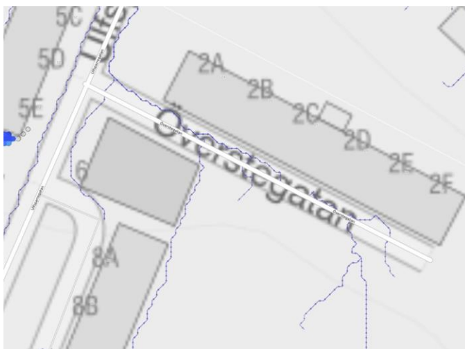
Figur 9. Resultat från lågpunktkartering med befintliga rinnvägar. Modellen har belastats med 70 mm regn. Ingen större vattensamling uppstår inom planområdet.
