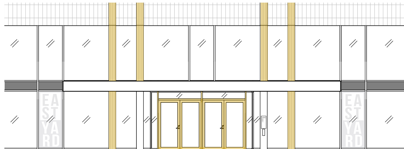
Skyltläge på glaspartier intill entréer.
