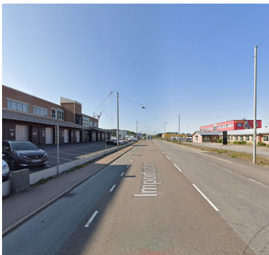
Figur 15: Belysningscentral och spännstolpar begränsar det fysiska utrymmet i gaturummet
